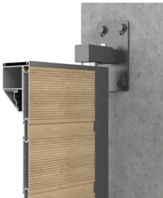
Λεπτομερείς προβολές των προφίλ του φύλλου και του αυλακωτού, μαζί με το προφίλ του άξονα περιστροφής και το PIN INOX 316 ικανό να αντέξει 250 κιλά το καθένα. Η μέγιστη διάσταση φύλλου είναι κοντά στα 5m 2 , με μέγιστο βάρος 80 Kg.
